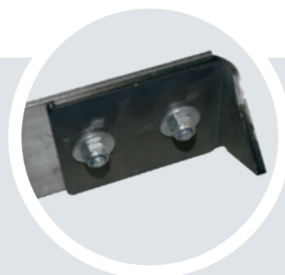
Bras du mélangeur avec crochets de déchirement
