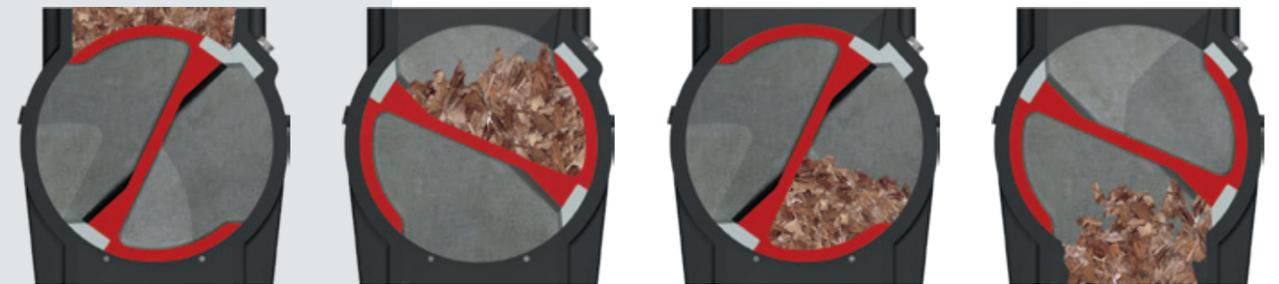
Die zwei großvolumigen Kammern eignen sich hervorragend für die Aufnahme von Hackgut bis P31S (ehemals G50). Großer Widerstand wird automatisch erkannt. Die Zellradschleuse und Schnecke laufen rückwärts (je nach eingestellten Parametern mehrmals) bis ein Weitertransport möglich ist.
