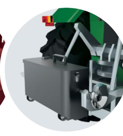
Praktische Hydraulik-Vorrichtung zum Transport mit dem Traktor und einfacher Entleerung (Kippen)\*
