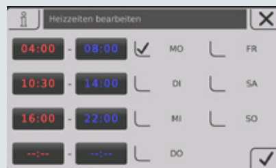
Abb. 2 Ansicht der Heizzeiten (individuell einstellbar)
