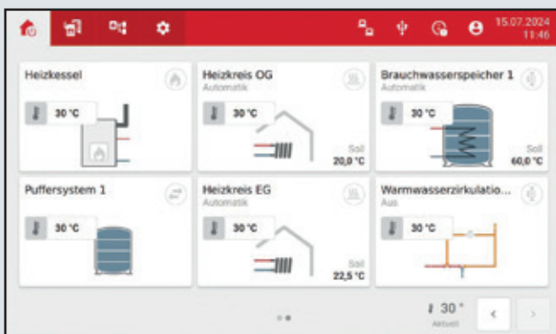
Übersicht der installierten Anlagen in Kacheldarstellung
