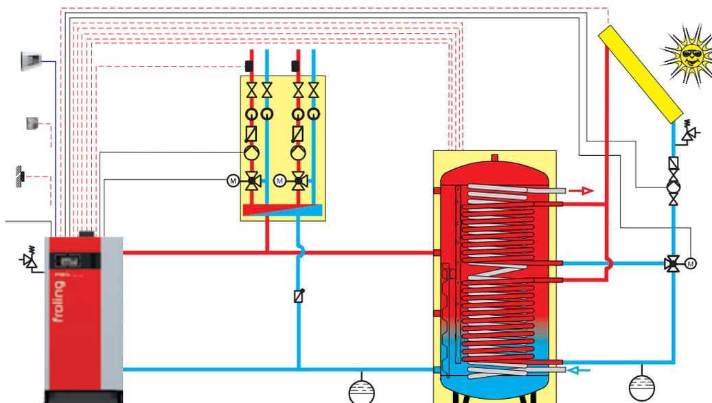
PE1e Pellet mit Hygiene-Schichtspeicher H2 und zweifacher Elektroheizpatrone
