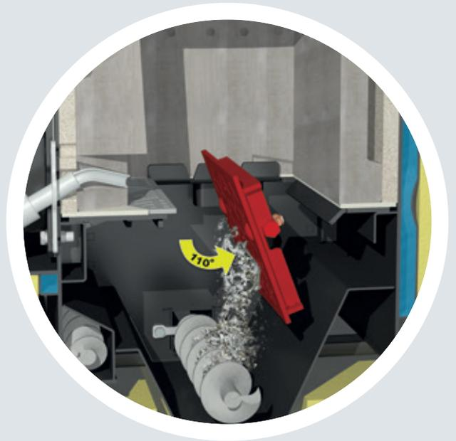
Durch die Neigung von 110° wird die Asche vollständig vom Kipprost geleert und mithilfe der Ascheschnecke in den großvolumigen, fahrbaren Aschebehälter ausgetragen.
