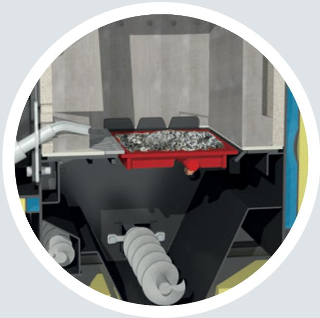
Ein zweiteiliger Verbrennungsrost bestehend aus einer festen Aufschubzone und automatischem Kipprost garantieren einen energiesparenden Betrieb und geringste Emissionen.
